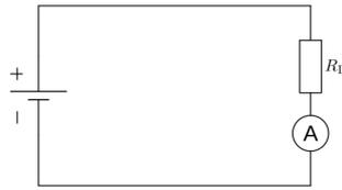
Abb. 77: Schaltung zur Messung von Stromstärken mittels eines Amperemeters.
